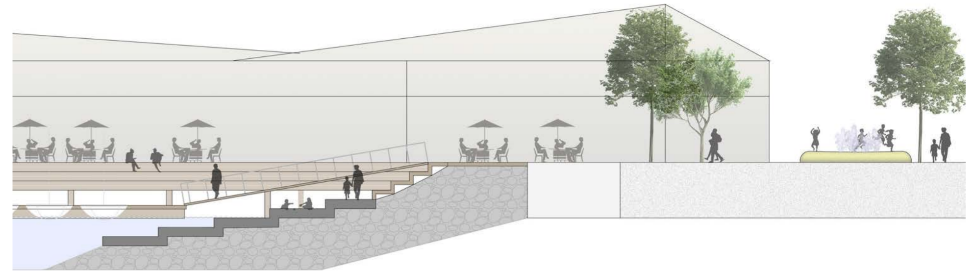
Hafnartorg Snið C-C' 1:200 Hafnartorg er miðlægur samkomustaður sem nær út í sjó með steyptum tröppum.
